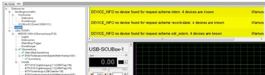
Durch linksklick auf eines der angeschlossenen Geräte werden die dort zur Verfügung stehenden Signale angezeigt. Dies sind in dem Beispiel unten alle Signale der SCU-Box mit ID 1. In den einzelnen Spalten sind die Signale nach Typ sortiert.
