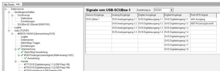
In der letzten Spalte Rob-SPS-Signal sollten die Signale aus der Robotersteuerung eingetragen werden, die an den jeweiligen Eingängen der SCU-Box angeschlossen sind. Insbesondere müssen hier die Synchronisationssignale für Messungen und Records eingetragen werden. Dieses Signal ist immer das Signal zum Start der Auswertung. Hierzu linksklick in eine leere Zelle oder rechtsklick und *ändern* wählen in einer bereits vergebenen Zelle und den folgenden Drop down Menü das Signal auswählen.
