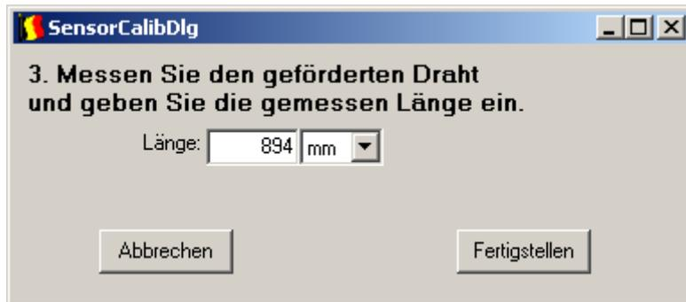
Diese Differenz ist der aktuelle Messfehler. Für die richtige Kalibration tragen Sie bitte nun den exakten Wert ein und bestätigen Sie Ihre Eingabe mit *Fertigstellen*. Nun ist der DrahtVGSensor kalibriert und messbereit.
