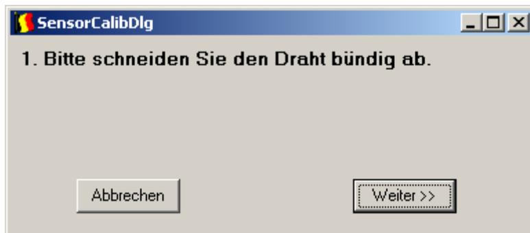
Wenn Sie den Draht an der Düse bündig abgeschnitten haben, drücken Sie weiter.
